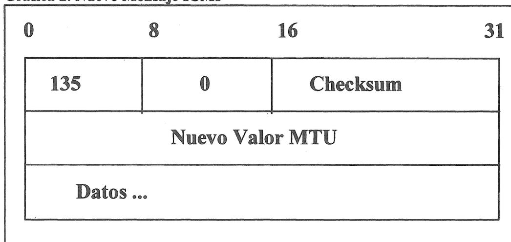
donde el mensaje ICMP con tipo 135 y con código 0 (cero) y donde en el segundo registro de 32 bits se indica el valor del nuevo MTU.
